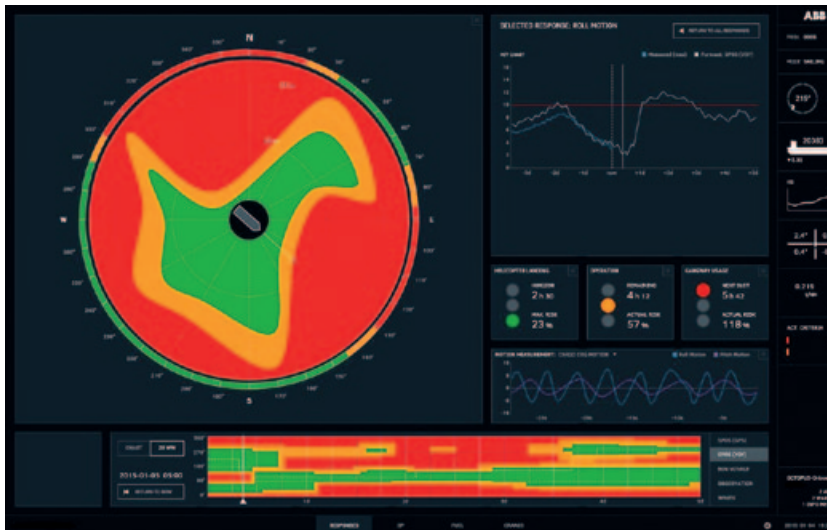
Aan de hand van scheepskarakteristieken en de weers- en zeeomstandigheden voorspelt de software welke bewegingen een schip gaat maken.
